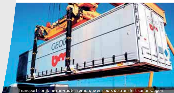
Transport combiné rail-route : remorque en cours de transfert sur un wagon.
